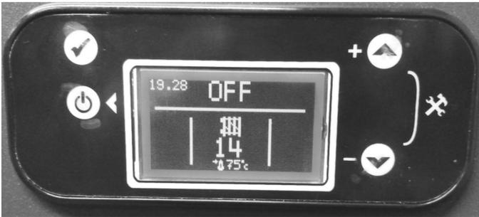
Durch gleichzeitiges Drücken der Plus- und der Minus-Tasten gelangen Sie in das Menü. Wählen Sie das Heizkörpersymbol aus
