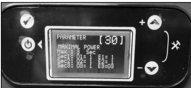
Bilder mit der Zustandsmarkierung bei Leistungsreduzierung. X zeigt den Zustand 0 oder AUS an, während 1 den Zustand EIN oder aktiviert anzeigt.
