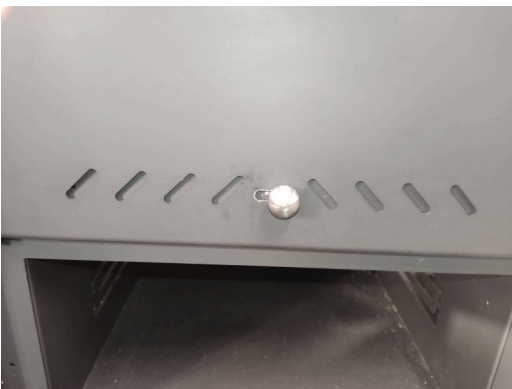
zatvoren ulaz primarnog zraka
